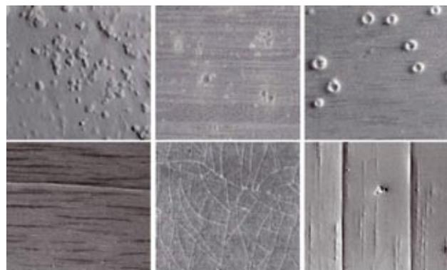
*Abb. 11: Beispiele topografischer Defekte: Ampullen, Blasen, Krater, Risse (einzeln und als Netz), vertikale Risse und Pickel.*
