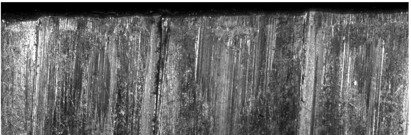
**Bild 12:** Ergebnis der Abwicklung des Mantels eines Projektils in Umfangsrichtung. Dargestellt sind ca. 30% des Mantelumfanges. Das Gesamtbild umfaßt  $5018 \times 512$  Pixel!
