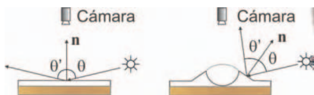
Figura 2: Superficie intacta (izquierda). Superficie defectuosa (derecha).
